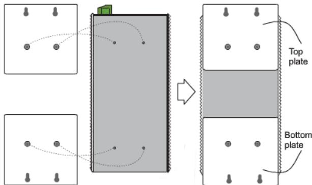
步骤 2：将交换机安装在墙面上，壁挂安装共需要 4 颗螺丝。
