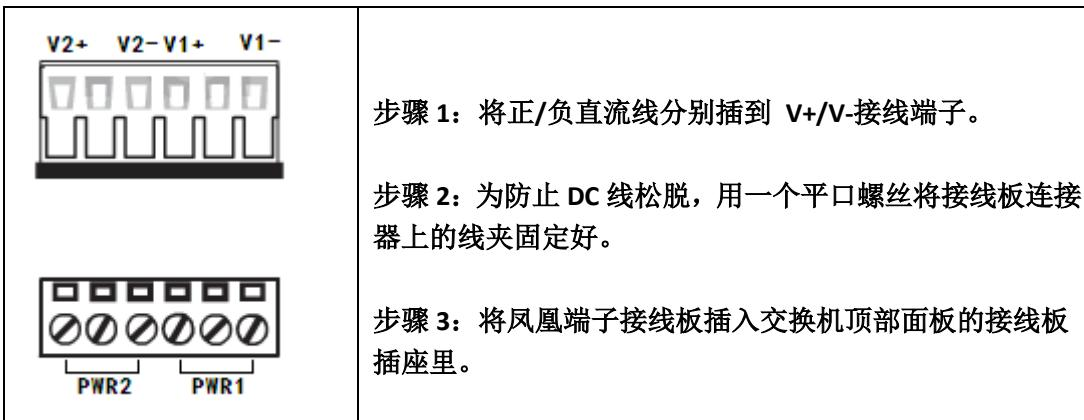
步骤 1：将正/负直流线分别插到 V+/V-接线端子。
